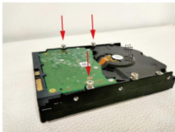
3.Wyrównaj złącze dysku twardego z interfejsem SATA na płycie głównej NVR, wyrównaj śruby z mocowaniem dysku twardego na płycie podstawy NVR i popchnij do góry, aby podłączyć dysk twardy do NVR.
